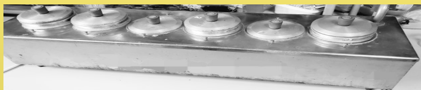
Рисунок 1 - Прибор определения развариваемости круп ПОР-1
